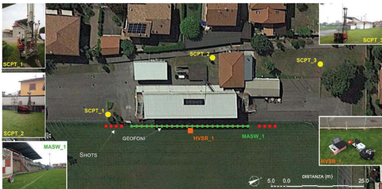
FIG. 4 - UBICAZIONE DELLE PROVE GEOTECNICHE E SISMICHE.
