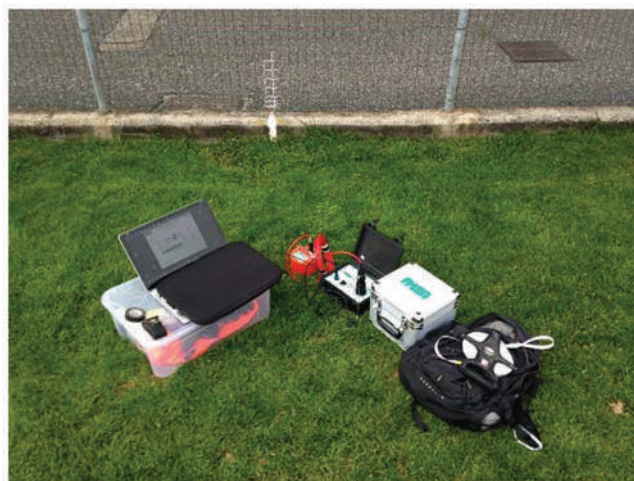
FIG. 5 - PASI GEA24 CON GEOFONO 3DLG.
