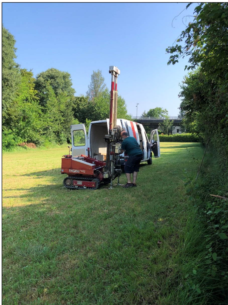
Figura 9 – Esecuzione prova penetrometrica PSP1
