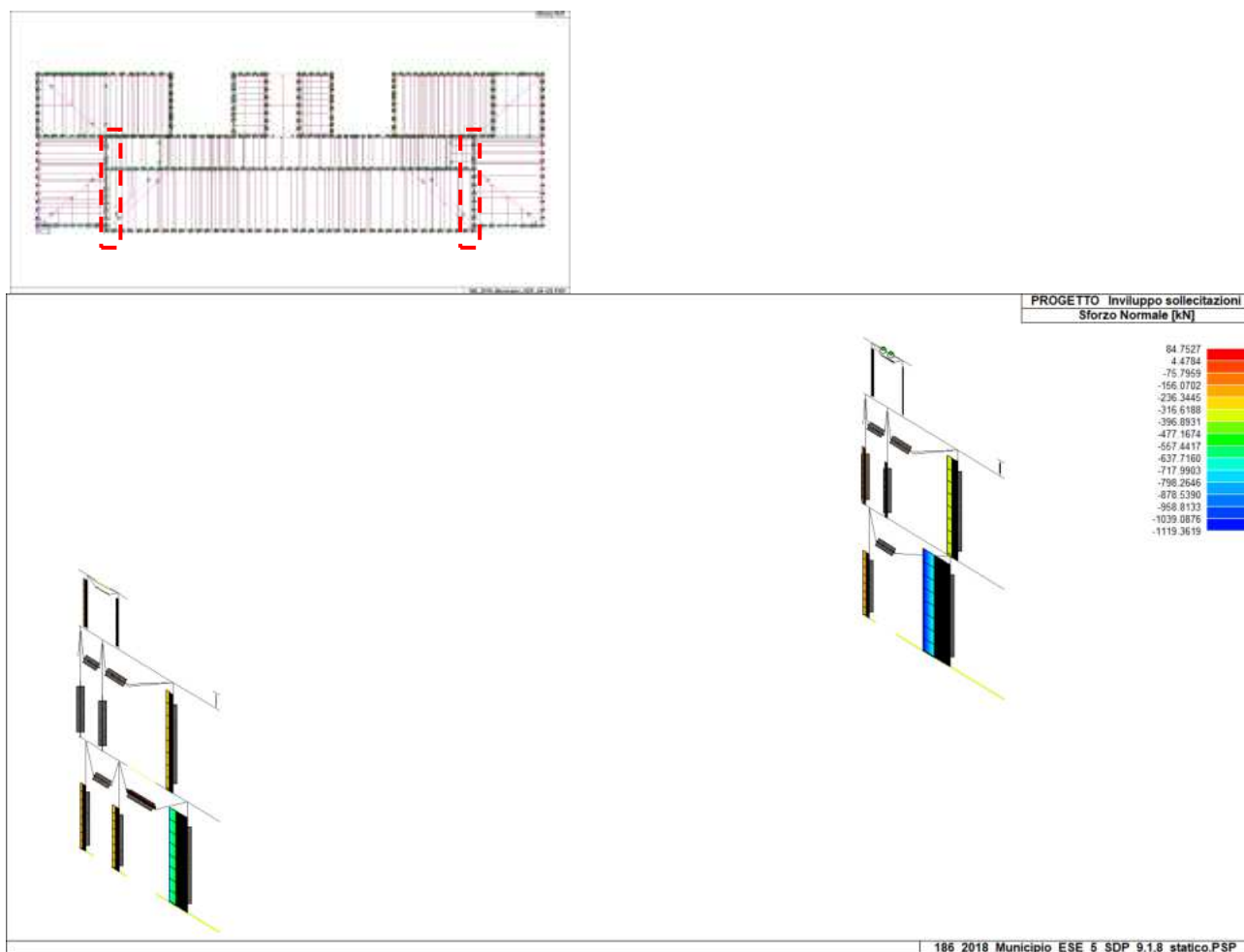
Figura 15: Max sforzo normale - CC4 - maschi e fasce laterali interni
