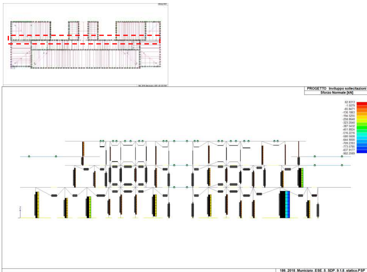
Figura 5: Max sforzo normale - CC4 - maschi e fasce Muro interno 2 direzione X
