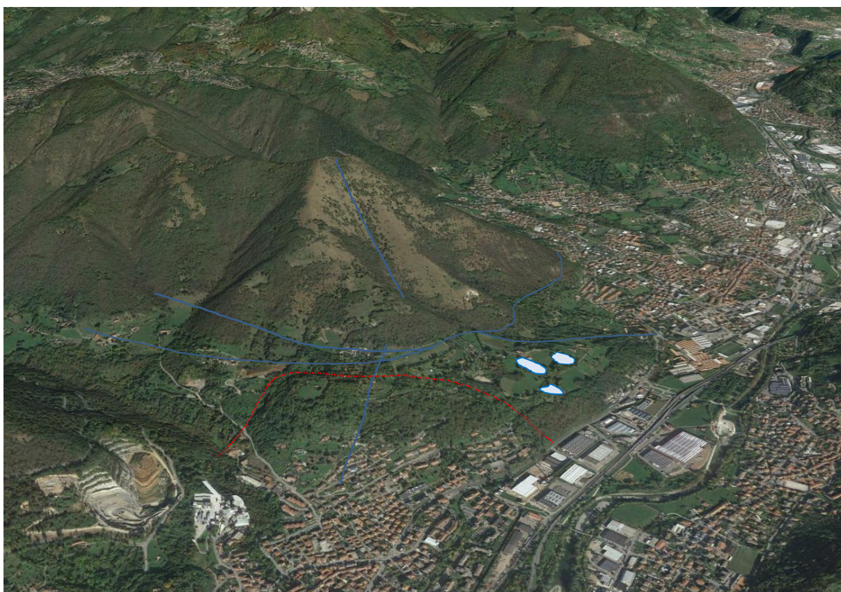
Figura 2 – Principali strutture morfologiche individuate: faglie (in blu), trincee d a DGPV (in rosso) e strutture carsiche superficiali (poligoni blu)
