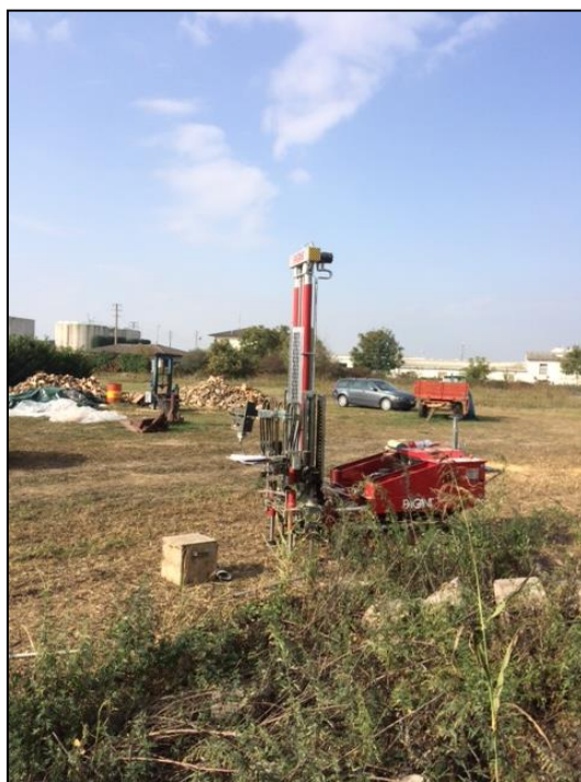
Figura 32 – Postazione prova CPT2 –
