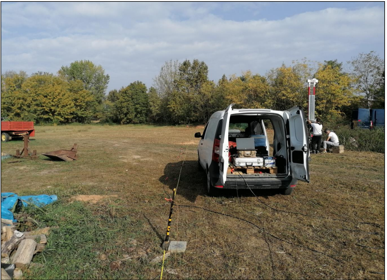
Figura 21 – Stendimento prospezione sismica MASW –
